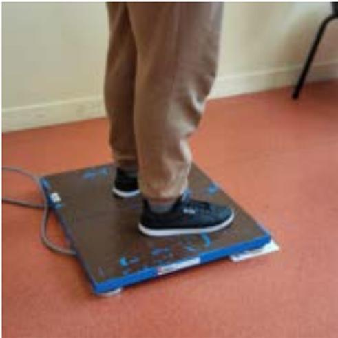
Cet appareil s'appelle une plateforme de force qui sert à détecter les forces exercées par notre corps sur le sol, et donc à détecter le moindre de nos mouvements.
