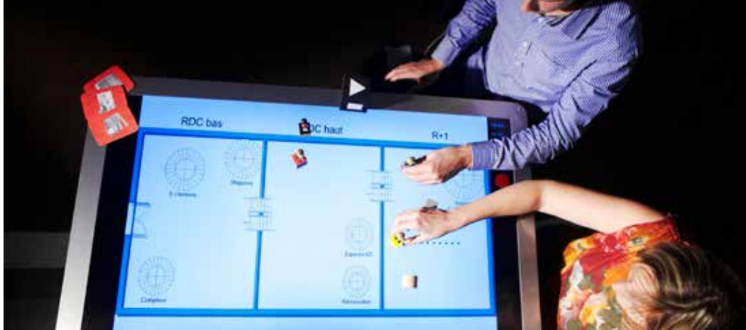
La table interactive avec technologie RFID (Radio Frequency Identification) du LAMIH
